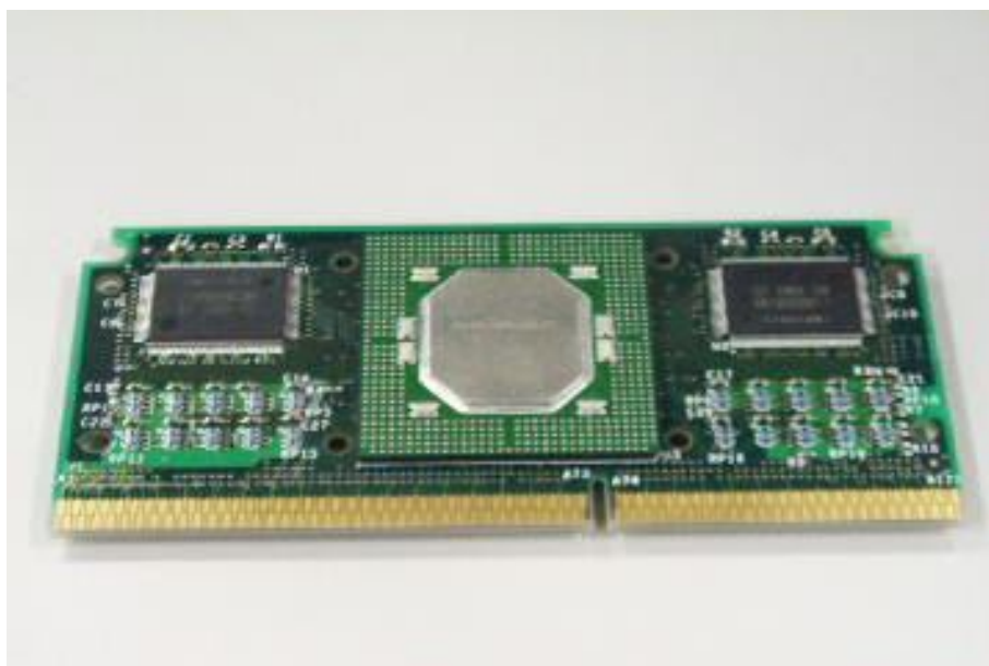
фиг. 1 Процесорна платка за Pentium II (вътре в SEC касетата).
