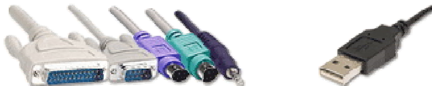
фиг. 1 Разнообразие от портове и конектори преди появата на USB
