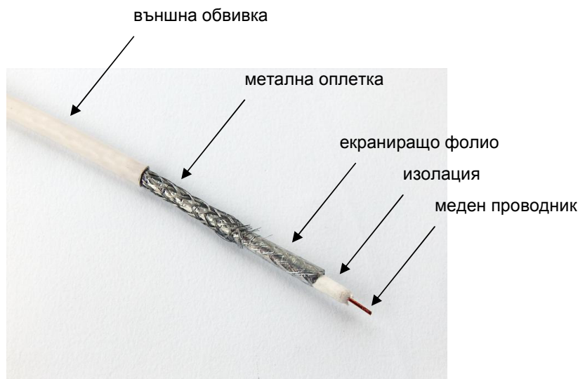
Фиг. 1-1. Коаксиален кабел
