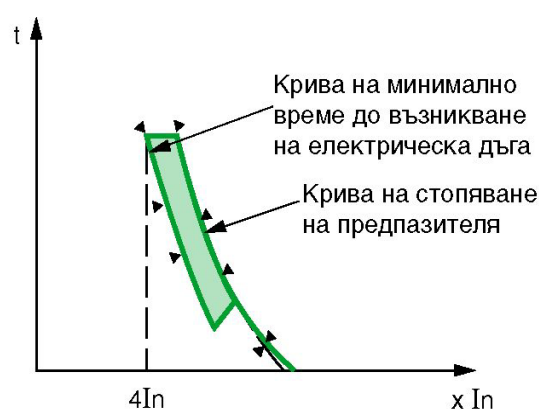
Фиг. 22.2. Стандартни зони на стопяване на предпазители от типа aM (всички номинални токове)
