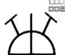
Условное обоз- начение двух выключателей и розетки в блоке для скрытой ус- тановки. IP20-IP23
