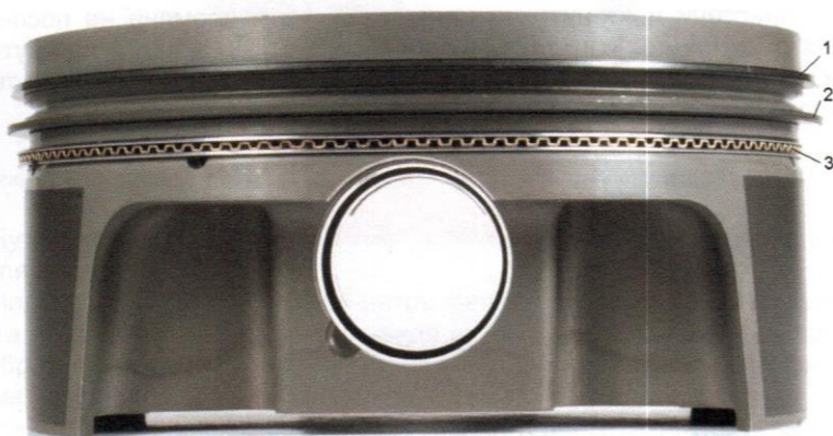
Фиг. 2.21. Разположение на буталните пръстени; 1-уплътнителен бутален пръстен; 2-уплътнителен и маслосъбирателен бутален пръстен; 3-маслосъбирач бутален пръстен.
