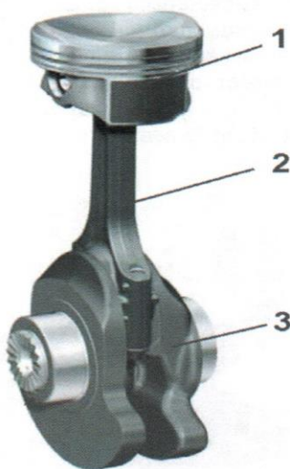
Фиг. 2.27. Мотовилка, свързана с бутало и колянвал: 1-бутало; 2-мотовилка; 3-колянвал.
