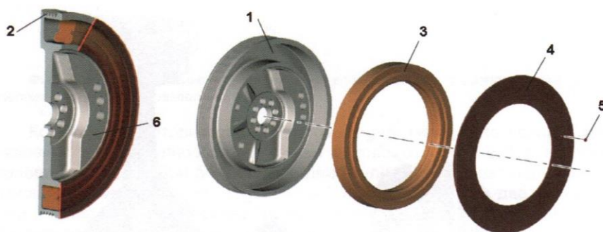
Фиг. 2.38. Демпфер: 1-ремъчна шайба; 2-канали за свързване на ремъка; 3-демфериращ елемент; 4-капак; 5-болт, 6-противотежест към колянвия вал.
