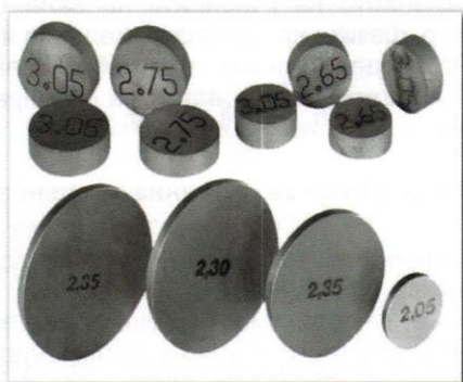
Фиг. 3.24. Регулиране на хлабините на клапаните, чрез използване на регулировъчни шайби с различни дебелини: 1-гърбица; 2-регулировъчна шайба; 3-повдигач.
