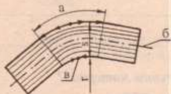
Фиг. 13 Деформации на метала при огъване
