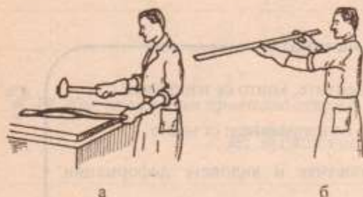
Фиг. 1. Изправяне на стоманена лента върху уравниелна плоча изправяне на метал
