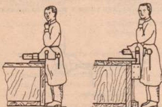
Фиг. 8 Проверяване работната височина на стиската а – на шлосерска стиска; б – на ковашка стиска
