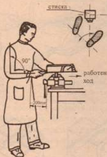
Фиг. 21 Правилен строеж при рязане с ножовка
