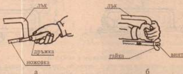
Фиг. 20 Хващане на ножовката а - с дясната ръка - за дръжката; б - с лявата ръка - за лъка
