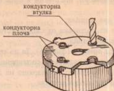
Фиг. 19 Пробиване с помощта на кондуктор
