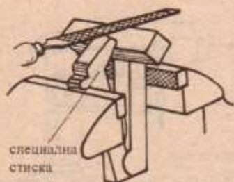
Фиг. 13 Закрепване на плосък детайл с помощта на специална стиска при обработка на ръбове
