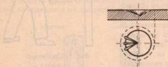
Фиг. 13 Поправяне на неправилно започнато пробиване чрез изсичане на канали
