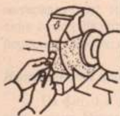
Фиг. 39 Държане на секача при заточване
