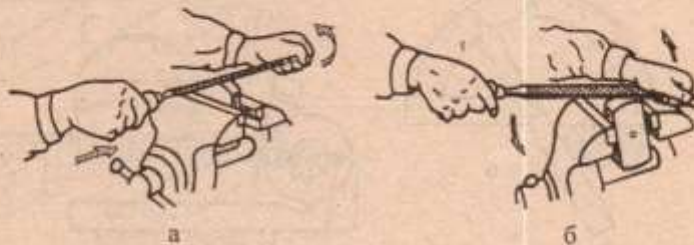
Фиг. 29 Изпиляване на изпъкнали повърхности
