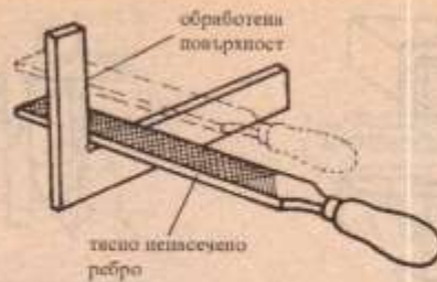
Фиг. 28 Изпиляване на плоскости под вътрешен прав ъгъл
