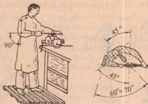
Фиг. 7 Положение на тялото при нормална височина на стиската
