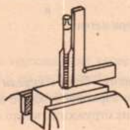
Фиг. 3 Контролиране с прав ъгълник поставянето на първия метчик
