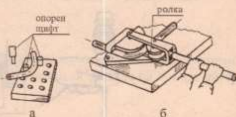
Фиг. 26 Огъване на тръба с приспособления а – плоча с отвори и опорни шифтове; б – чрез ролка
