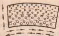
Фиг. 3 Схема на изправяне на тънка стоманена лента, огъната по тясната страна
