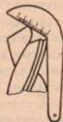
Фиг. 7 Проверка на ъгъла на заточване на свредлото с помощта на шаблон
