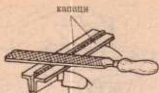
Фиг. 17 Закрепване на тънки детайли при изпиляване на тесните им плоскости
