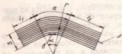
Фиг. 1.58. Деформации на метала при огъване
