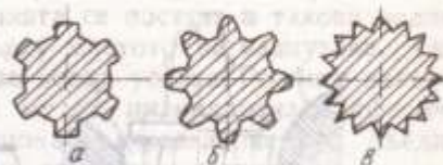
Фиг. 3.30. Профили на шлицови зъби: а — правоъгълен; б — еволвентен; в — триъгълен
