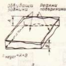
Фиг. 1.28. Неуспоредност на равнинни повърхнини
