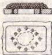
Фиг. 4.20. Залепване на пробна със стъклотъкан
