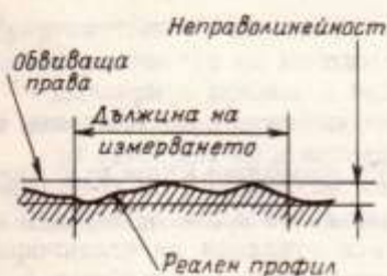
Фиг. 1.25. Неправолинейност на равнинна повърхнина
