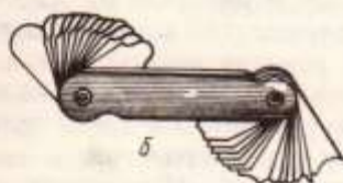
Фиг. 1.8. Шаблони а — резбомери; б — радиусни шаблони
