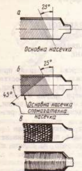
Фиг. 1.73. Видове насечки на пилата
