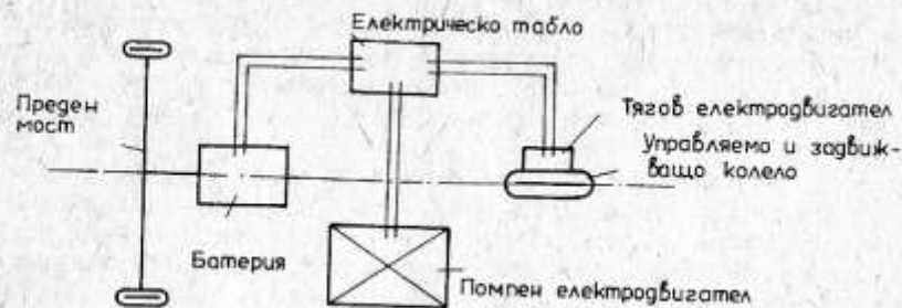
Фиг. 1.3. Схема на триопорен електрокар високоповдигач — колонно задвижване
