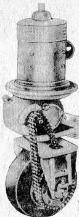
Фиг. 1.12. Двигателен мост: тягов двигател, двустепенен редуктор, диференциал и двигателен мост
