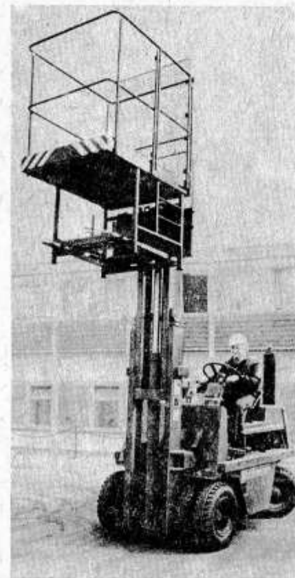
Фиг. 6.8. Мотокар високоповдигач DFG 3002 с работна платформа
