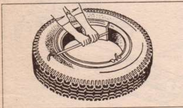
Фиг. 3.8-2. Разглобяема джанта — за товарни автомобили и автобуси
