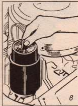
Фиг. 1.9-10. Контрол на налягането на маслото в маслената магистрала с манометър
