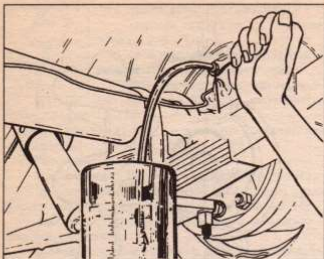
Фиг. 4.2-17. Обезвъздушаване на хидравлично спирачно задвижване
