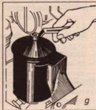
Фиг. 1.9-9. Операции при смяне на филтриращия елемент на разглобяем филтър
