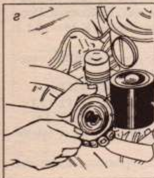
Фиг. 1.9-9. Операции при смяне на филтриращия елемент на разглобяем филтър
