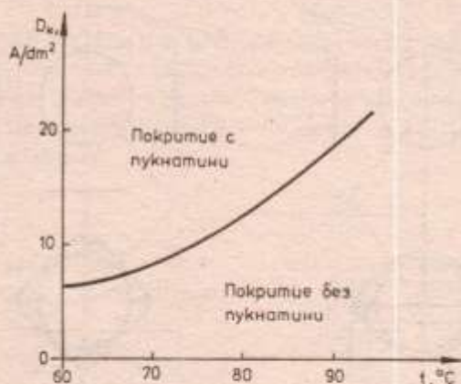
Фиг. 5.34. Зависимост на вида на покритието от режима на електролизата
