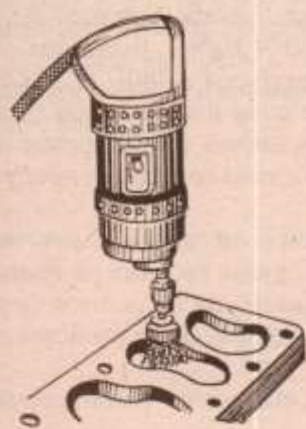
Фиг. 4.13. Почистване на нагара от цилиндровата глава с четка
