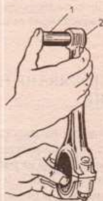
Фиг. 6.22. Подбиране на буталния болт към втулката в горната глава на мотовилката
