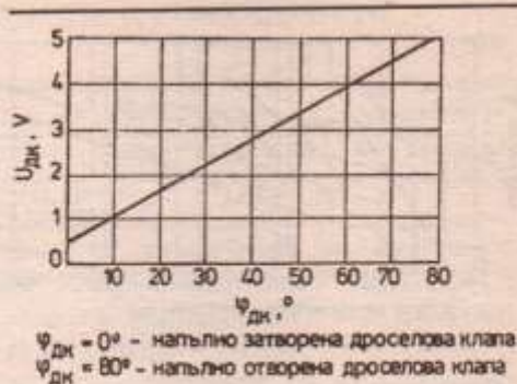
Фиг. 11.61. Зависимост на изходното напрежение на преобразувателя на положението на дроселовата клапа U_{\text{ДК}} от ъгъла на отварянето ѝ \psi_{\text{ДК}}
