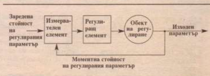
Фиг. 4.1. Структурна схема на автоматичен регулатор, илюстриращ принципа на действие на реле-регулатора
