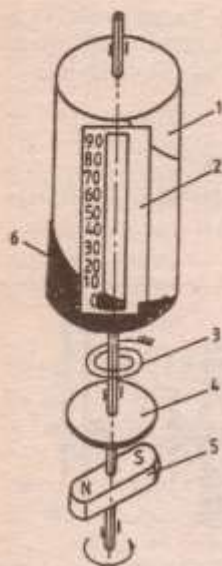
Фиг. 9.12. Принципно устройство на скоростомер с вертикална скала 1 – цилиндър; 2 – скала; 3 – пружина; 4 – алуминиев диск; 5 – постоянен магнит; 6 – винтова линия
