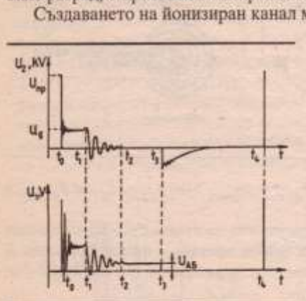
Фиг. 12.30. Осцилограми на напрежението във вторичната U_2 и първичната U_1 верига на технически изправна запалителна уредба
