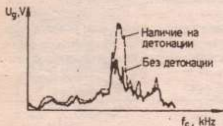
Фиг. 6.36. Характеристика на преобразувателя на детонации при постоянна честота на въртене на колянвия вал
