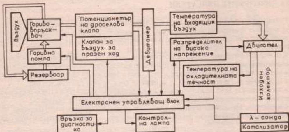
Фиг. 11.29. Структурна схема на горивна уредба с централно впъскване на горивото („Монотроник“)
