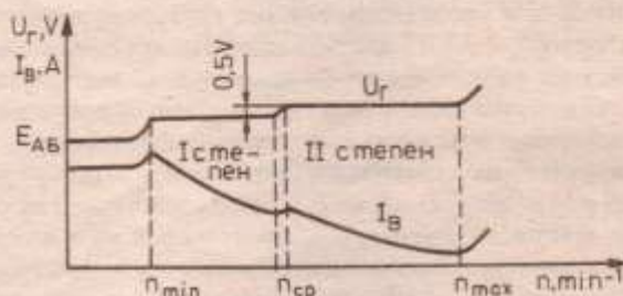
Фиг. 4.6. Работна характеристика на генератор, работещ с двустепенен регулатор на напрежение
