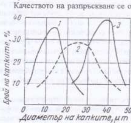
Фиг. 3.2. Характеристика на разпръскване на горивото
