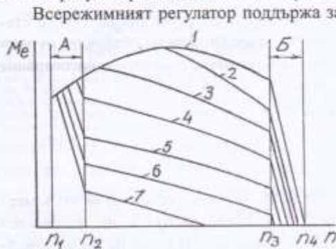
Фиг. 3.45. Честотни характеристики на дизелов двигател с комбиниран регулатор:
