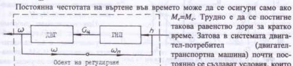
Фиг. 1.40. Структурна схема на двигателя като обект на регулиране
