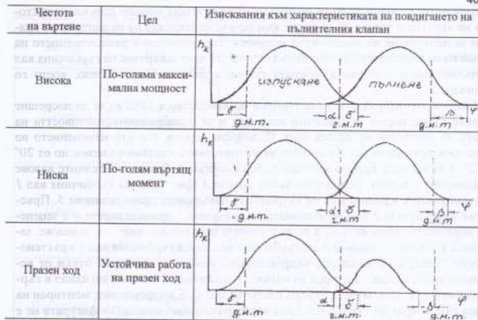
Фиг. 1.28. Характеристики на променливи фази, повдигане и продължителност на отвореното състояние на клапаните
