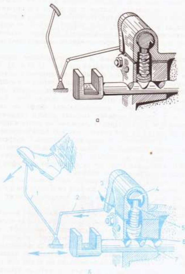
Фиг. 11.23. Блокиращо приспособление към предавателната кутия
