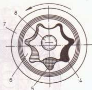
Фиг. 5.6. Схема на зъбно-роторна маслена помпа
